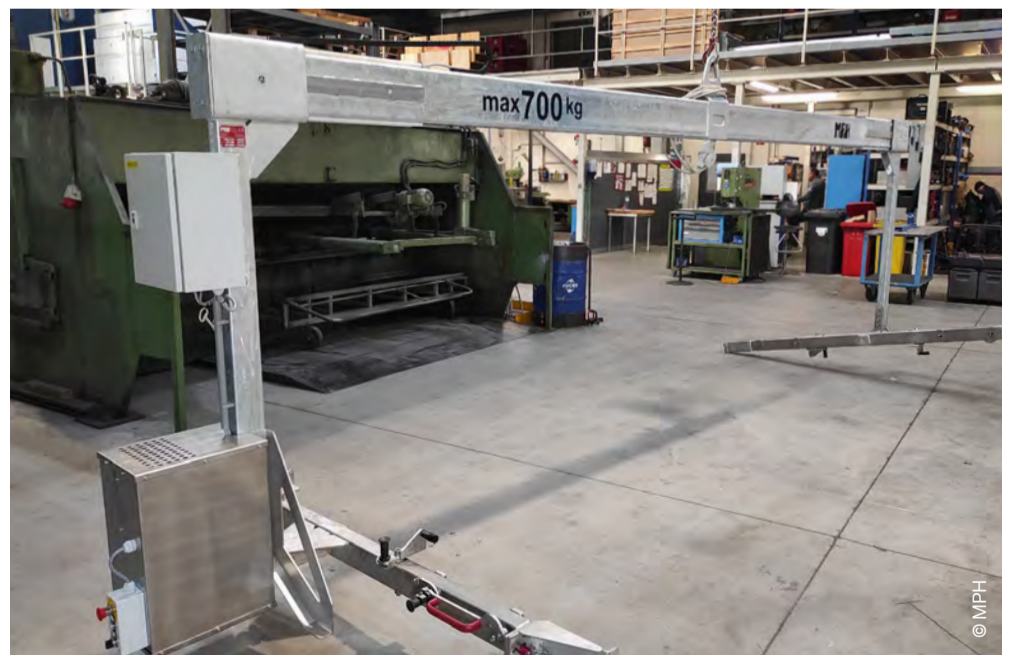
Das Wendegehänge, eine Sondermaschine, realisiert MPH von der Skizze bis zur fertigen Anlage aus einer Hand.
