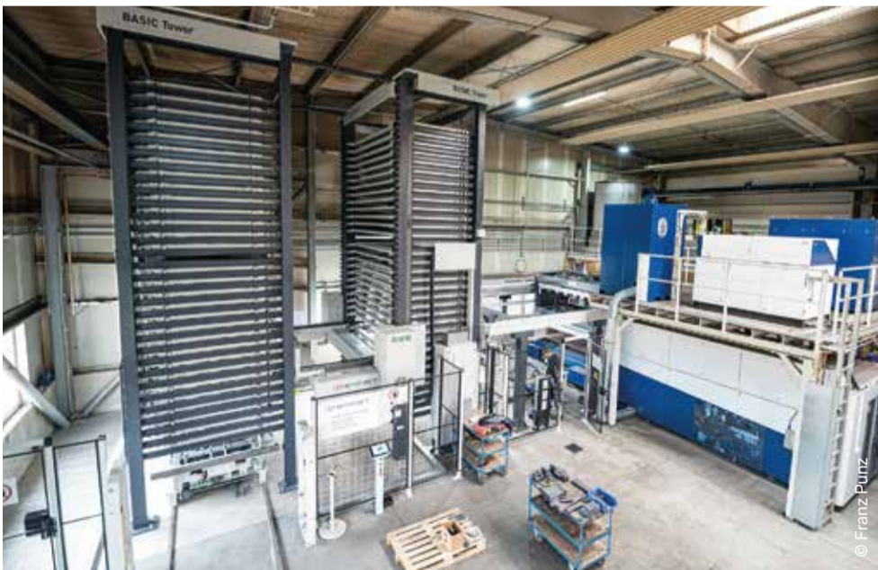
Das vollautomatische Blechlager arbeitet effizient und schnell – auch nachts.
