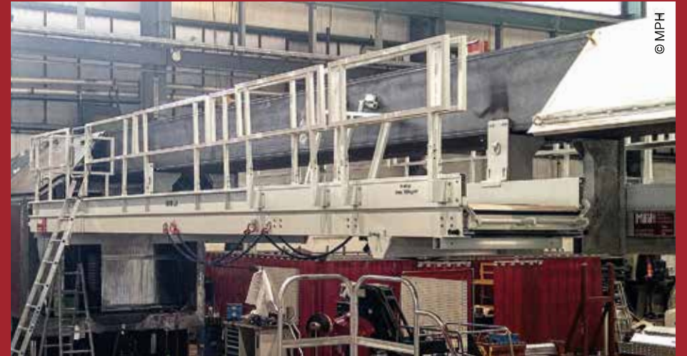
Ca. 9 m lang und 1 m breit ist die mobile Arbeitsbühne, die MPH für Plasser & Theurer fertigte.
